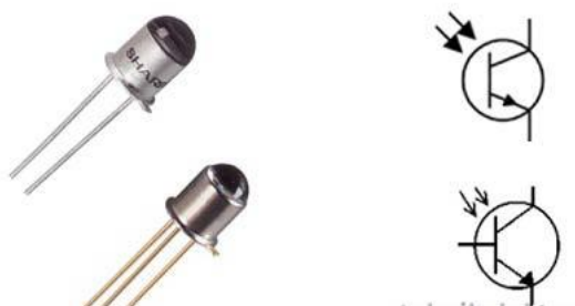
Gambar 1. Bentuk dan Simbol Fototransistor
