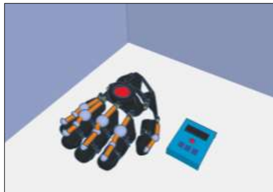
Gambar 3. Desain 3D Alat soft-actuator exoskeleton glove dengan alat getar
