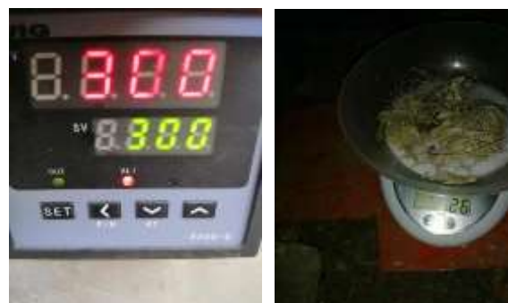
Gambar 4. Pengujian yang dilakukan pada suhu 300 °C menghasilkan berat 26gr
