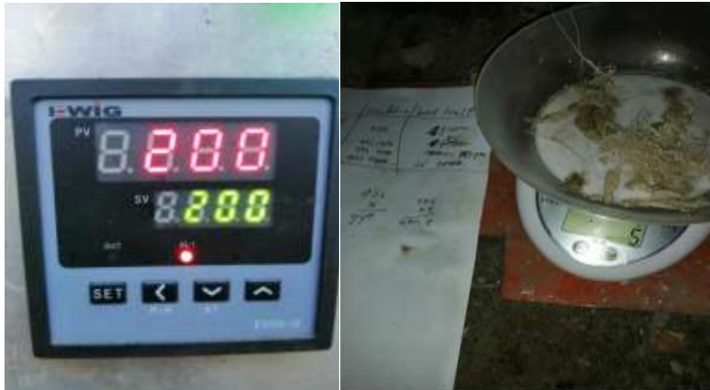
Gambar 2. Pengujian yang dilakukan pada suhu 200 °C menghasilkan berat 5gr
