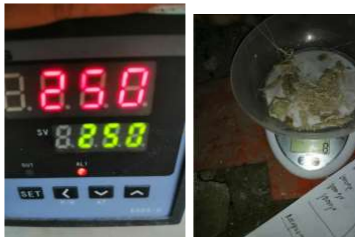
Gambar 3. Pengujian yang dilakukan pada suhu 250 °C menghasilkan berat 8gr
