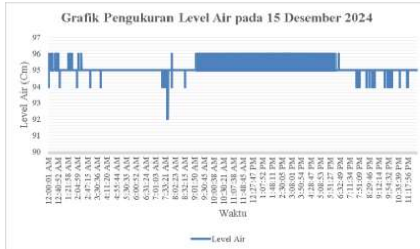
Gambar 7. Grafik Pengujian Sensor JSN-SR04T
