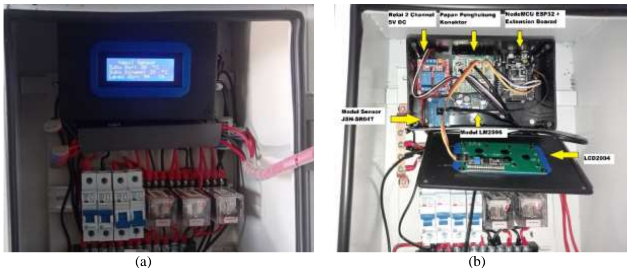
Gambar 3. Perangkat Keras Sistem (a) Tampak Luar (b) Tampak Dalam
