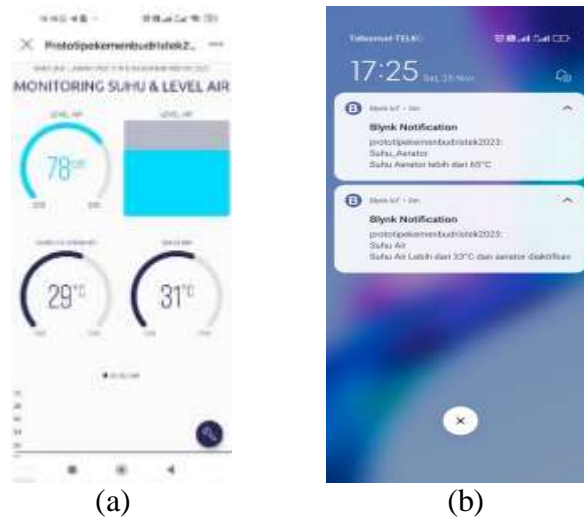
Gambar 5. Tampilan Data pada Android (a) Data Sensor (b) Notifikasi Parameter Tidak Optimal
