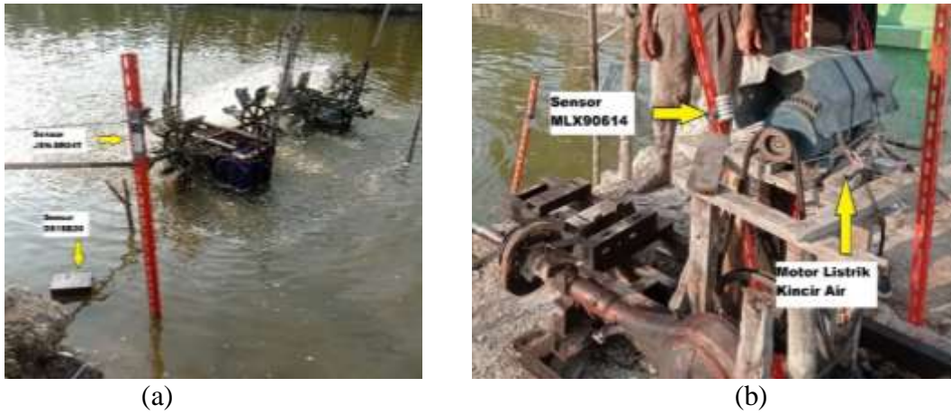
Gambar 4. Tampilan Pelindung Setiap Sensor (a) JSN-SR04T dan DS18B20 (b) MLX90614
