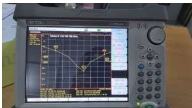
Gambar 8. Hasil Pengukuran Return Loss dan Bandwidth Antena Hasil Pabrikasi
