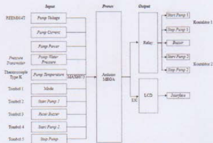
Gambar 2. Diagram Blok Sistem
