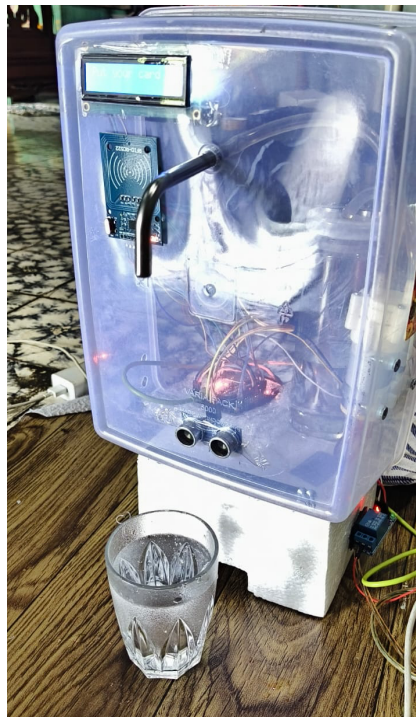
Gambar 9. Pengujian Sensor Ultrasonik & Pompa Air
