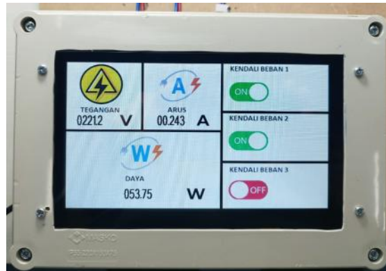
Gambar 7. Tampilan layar HMI display
