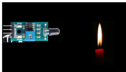
Gambar 7. Objek lilin dan sensor flame
