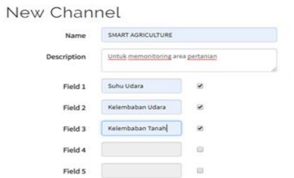
Gambar 11. Antarmuka pembuatan channel pada aplikasi thingspeak
