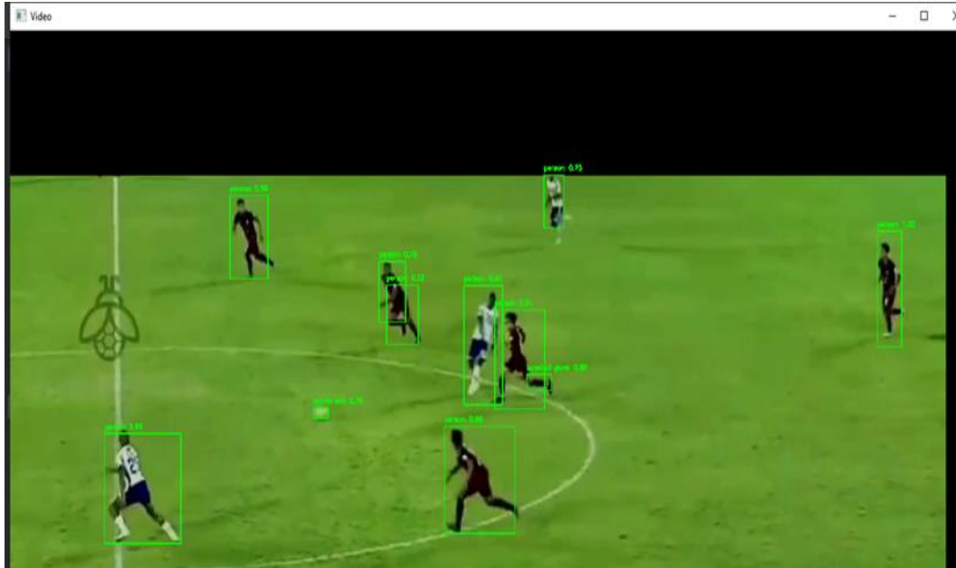
Gambar 2 Tampilan Deteksi Objek Menggunakan YOLO
