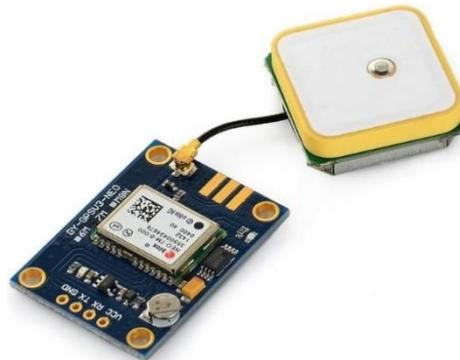
Gambar 7 modul GPS NEO-6M
